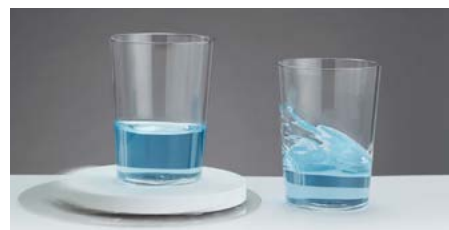
テーブルの横揺れ実験 (左)グラレス上の水入りコップ (右)グラレスなし
